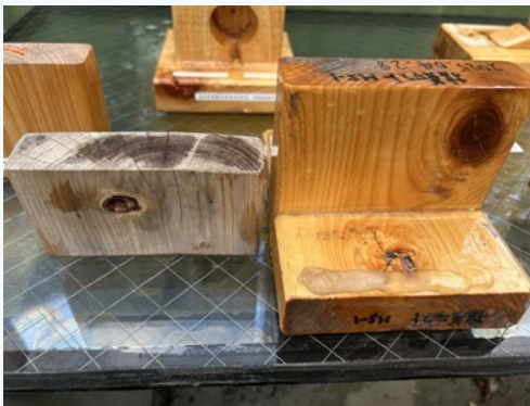
左は未施工・右はウレアコーティング
