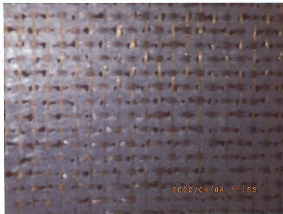
高機能繊維や金属メッシュなどを入れシート化 アラミドウレアシート：片面のみ吹き付けた写真
