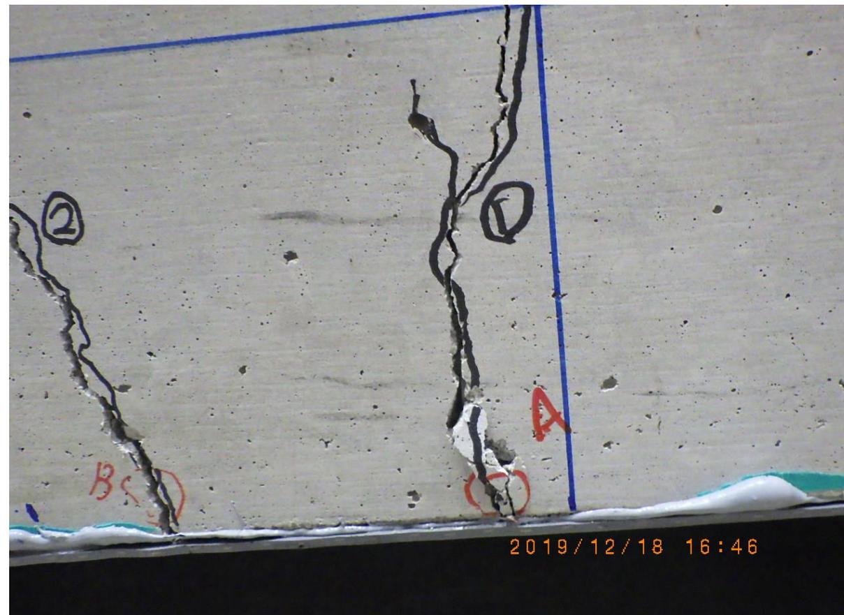
アムスラーによる耐力テストの結果；リムシートには破損無し
