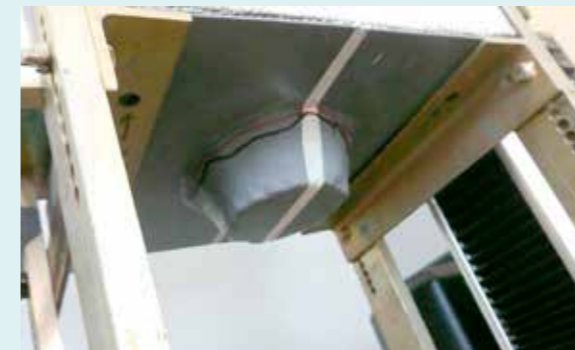
リムシート 押抜き試験写真
